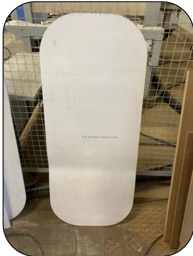
Pièce pour vasque après usinage
