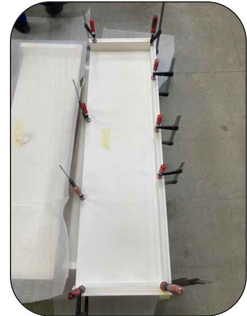
Maintien des renforts durant le collage
