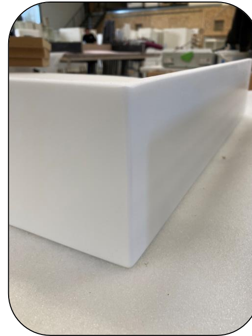
Aucun joint visible
