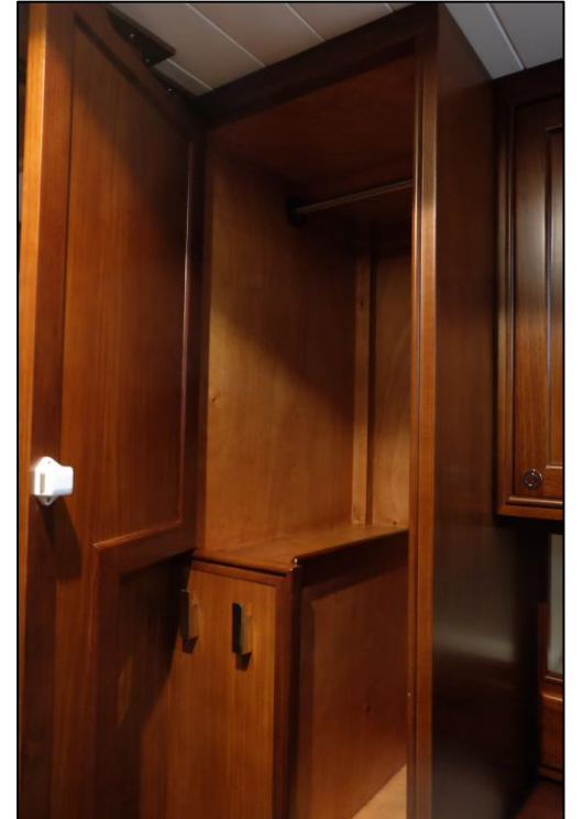
Gâchette de sécurité pour garantir la fermetures des portes par tout temps
